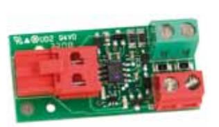
Interfaz BUS XIB (Si la tarjeta E024S se utiliza con fotocélula no Bus)
